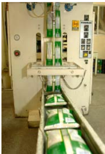
La planta de Arroz Sabanero tiene una capacidad de producción de 50 bolsas de un kilo por minuto.
