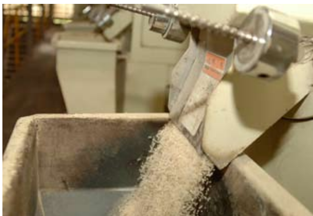
El color blanco del grano que usted consume se logra gracias a un sistema de pulido y limpieza con agua.
