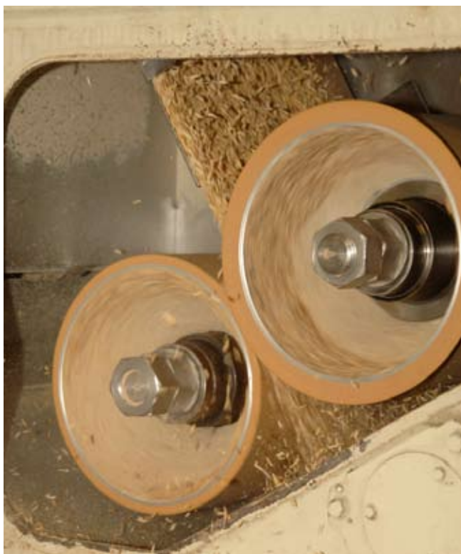
La granza de arroz es descascarada en esta máquina, que funciona por presión.
